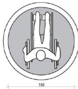
Σχήμα 6: Το αναπηρικό τροχοκάθισμα ή καρέκλα έχει βασικές διαστάσεις και ο τρόπος κίνησης του επιτρέπει την πλήρη επιτόπια στροφή που περικλείεται σε κύκλο διαμέτρου 1,50 μ.
